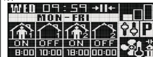
Пример запрограммированного календаря (рабочие дни). Устройство будет включено в 8:00 и будет выключено в
