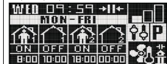
Un exemplu de programare calendar (zile lucrătoare). Dispozitivul va porni la ora 8 dimineața și va fi oprit la ora 10 a.m. Se va reporni la ora 6 dimineața. și va fi oprit la ora 12:00. Ciclul va fi repetat de luni până vineri.
